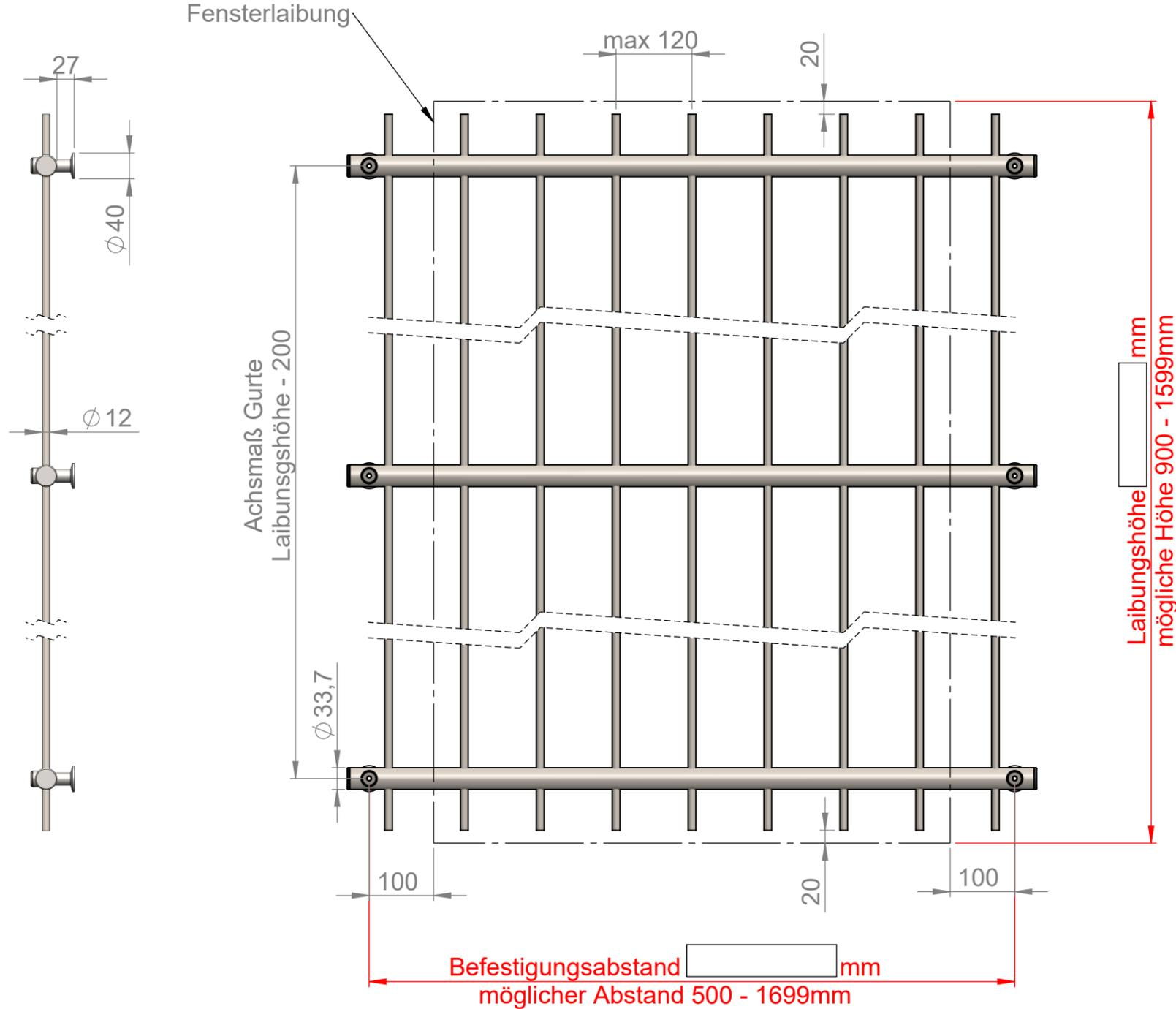
Gurte:  $\phi 33,7 \times 2,0\text{mm}$
