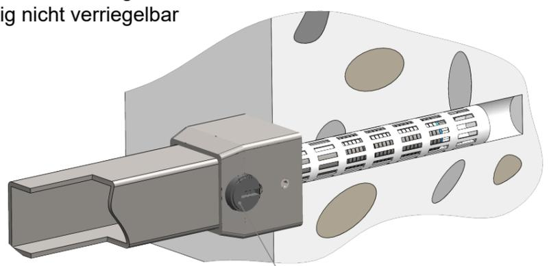
Ausrichtung des Schließzylinders nach unten
