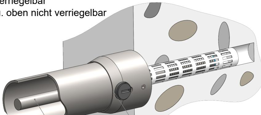
Ausrichtung des Schließzylinders nach unten
