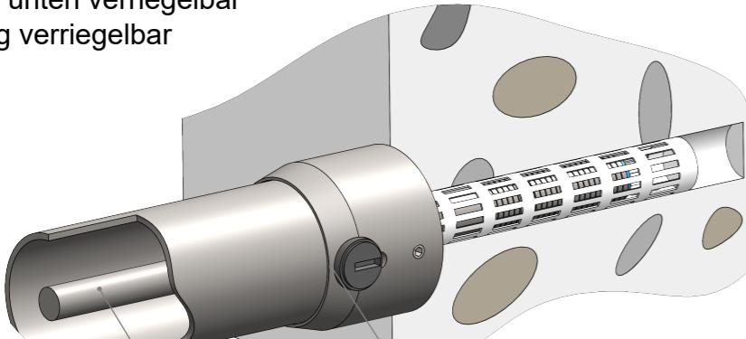
Ausrichtung des Schließzylinders nach unten
